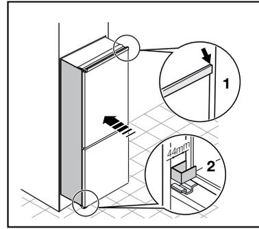
Fissare l'apparecchiatura con le 4 viti in dotazione.
